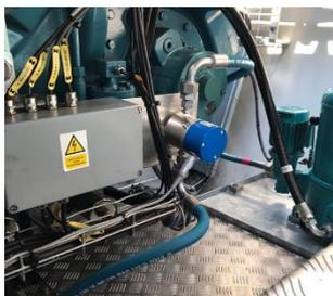
테스트벤치에 있는 기어와 베어링의 테스트 및 개발 단계에서 센서는 마모 메커니즘에 대한 필수적인 사실을 제공합니다. 테스트 프로토콜의 상관관계로 인해 부품 최적화가 가능합니다.
