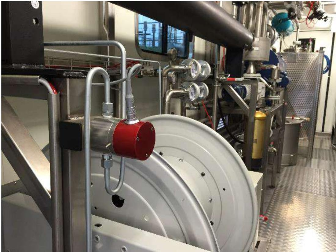
그림 6. 오일 재생 설비의 바이패스에 설치된 오일 센서
